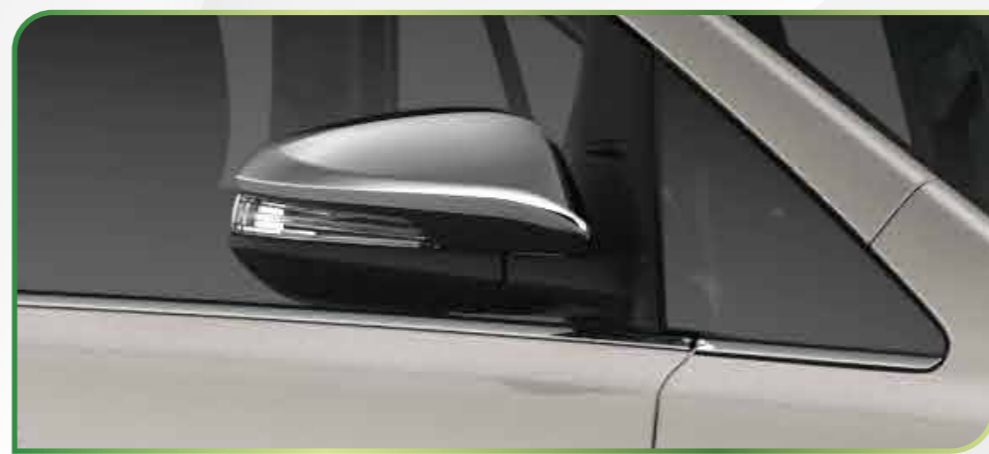
Gương chiếu hậu ngoài (Gập điện) Gương chiếu hậu bên ngoài có chức năng chỉnh điện, gập điện, tích hợp đèn báo rẽ cùng đèn chào mừng độc đáo, được mạ crôm cho vẻ sang trọng, trang nhã.
